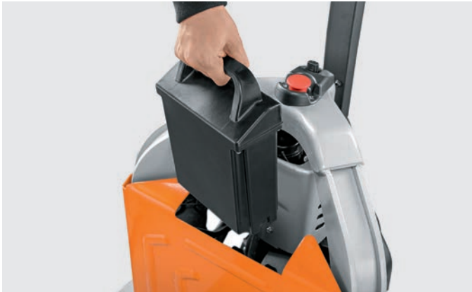
Hızlı ara şarj seçeneğine sahip Li-Ion akü sayesinde üstün kullanılabilirlik
